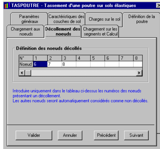
Figure I. 14 : Module TASPOUTRE – Décollement des nœuds
