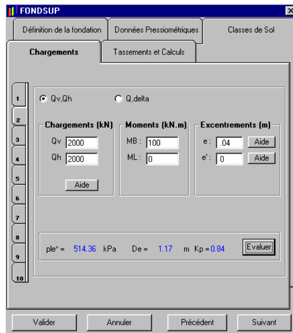
Figure J.22 : Module FONDSUP – Chargement et Moments.
